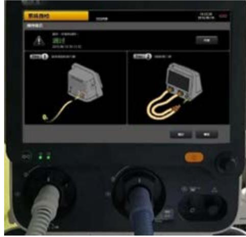
2.打开主机、连接呼吸机管路
