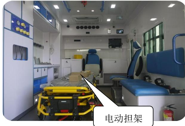
图 1：电动担架示意图
