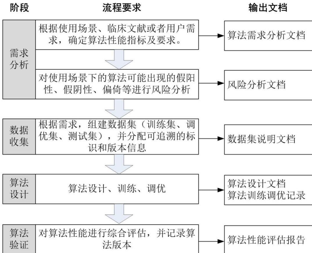
图A.1 算法可追溯性流程图
